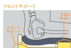
3辺に設けたスラントサポートが骨盤の後傾や左右の傾きを抑制します。
